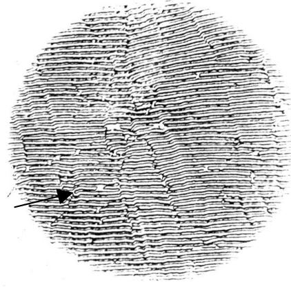
Рис.4. Участок ветвления базовой фазы, сплава Ni-4,2 мас.%B, R = 220 \text{ мм/ч} , продольное сечение, \times 650 .
