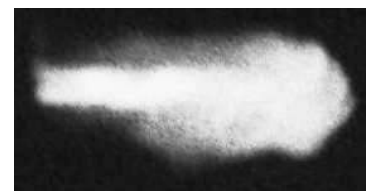
Рис. 7. Форма светящейся области, получаемой при низкой напряженности поля электрического разряда.
