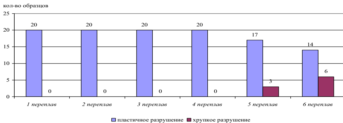
Рис.4. Распределение образцов по типам разрушения при последовательных переплавах сплава Remanium Cse
