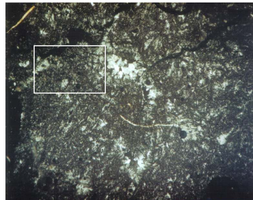
Рис.2. Микроструктура облученного \gamma -квантами ( D=3 \cdot 10^8 Гр) туфа с включением пепловых частиц и миндалинок (в квадрате), заполненных новообразованным полевошпатово-кварцевым материалом. Увеличение 100. а – съемка без анализатора. Стрелками показана система развивающихся механических трещин. б – съемка в скрещенных поляриоидах. В миндалевидных включениях видны агрегаты вторичного кварца и альбита с мозаичным и веероидным погасанием.
