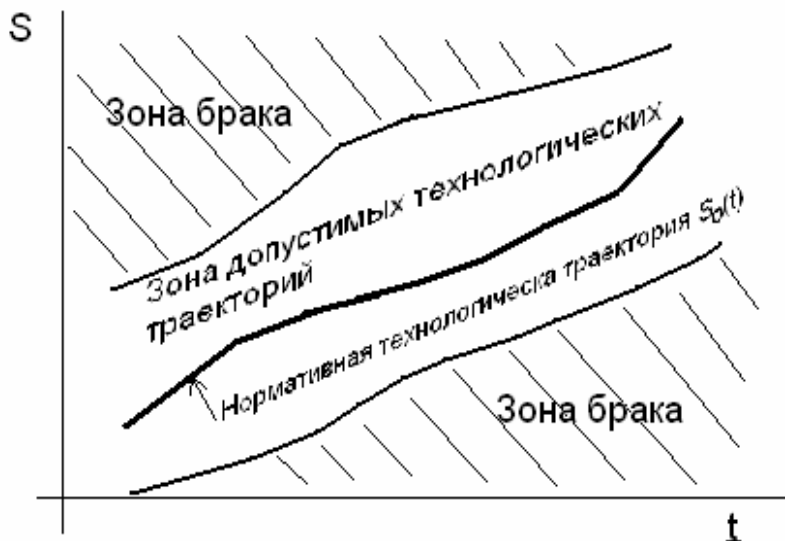
Рис.1. Зона допустимых технологических траекторий
