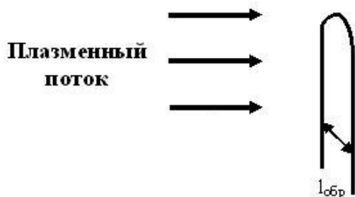
Рис. 1. Схема ориентации проволочных образцов относительно плазменного потока. l_{обп} – расстояние между образцами
