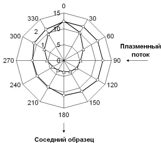
Рис. 6. Угловое распределение толщины пленки (радиальная ось – толщина в мкм) по боковой поверхности проволоки при различных расстояниях между ними:
