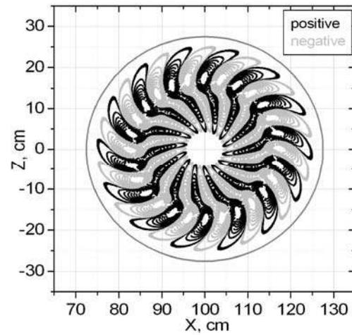
Fig. 4. Equipotential lines of the electric field.
