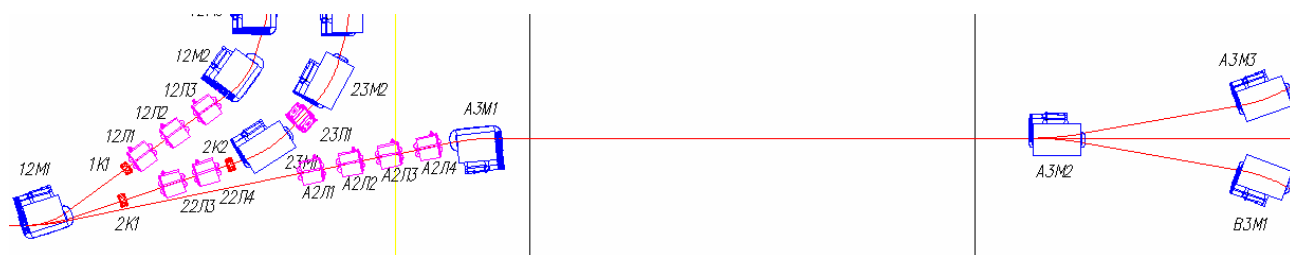
Рис. 2. Магнитооптическая система линий А, В и С.
