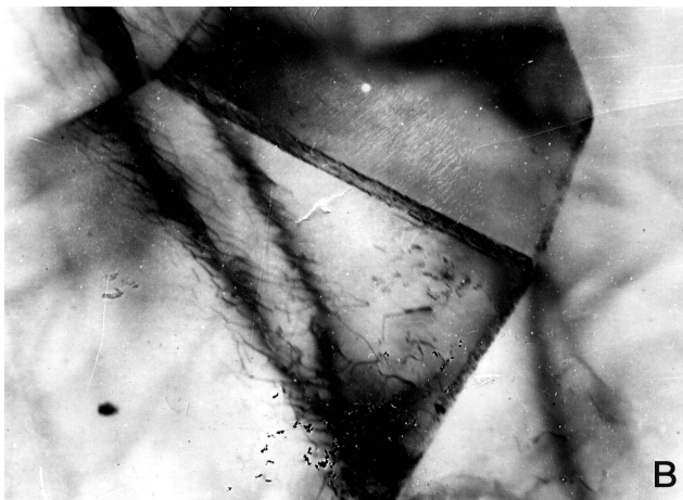
Рис. 8. Микроструктура образцов прокатанного при температуре 800°C бериллия: исходное состояние (а); отжиг 700°C 1 час (б); отжиг 900°C 1 час (в)
