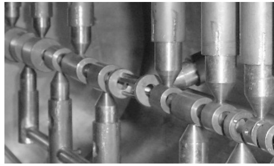
Рис. 7. Реализация варианта трехзазорной ВЧК ячейки с двумя промежуточными трубками дрейфа на модели
