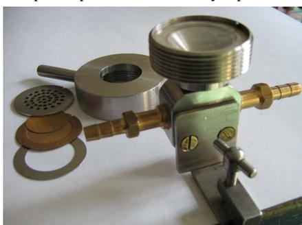
Рис. 4. Измерительная ячейка перед сборкой с набором сеток.
