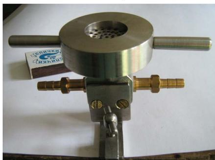
Рис. 3. Измерительная ячейка для определения диаметров пор методом точки пузырька.
