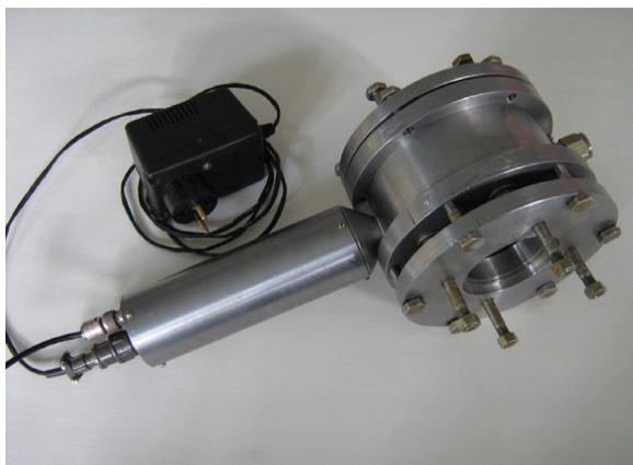
Рис. 5. Индукционный датчик с переходными фланцами для установки в вакуумном тракте ускорителя.
