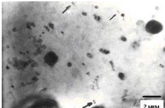
Рис.4. Когерентные включения в сплаве X16H8 + 0.1%TiN + 0.1%Zr, после отжига при T=800^\circ C в течении 5 час и при T=1050^\circ C в течении 30 мин.
