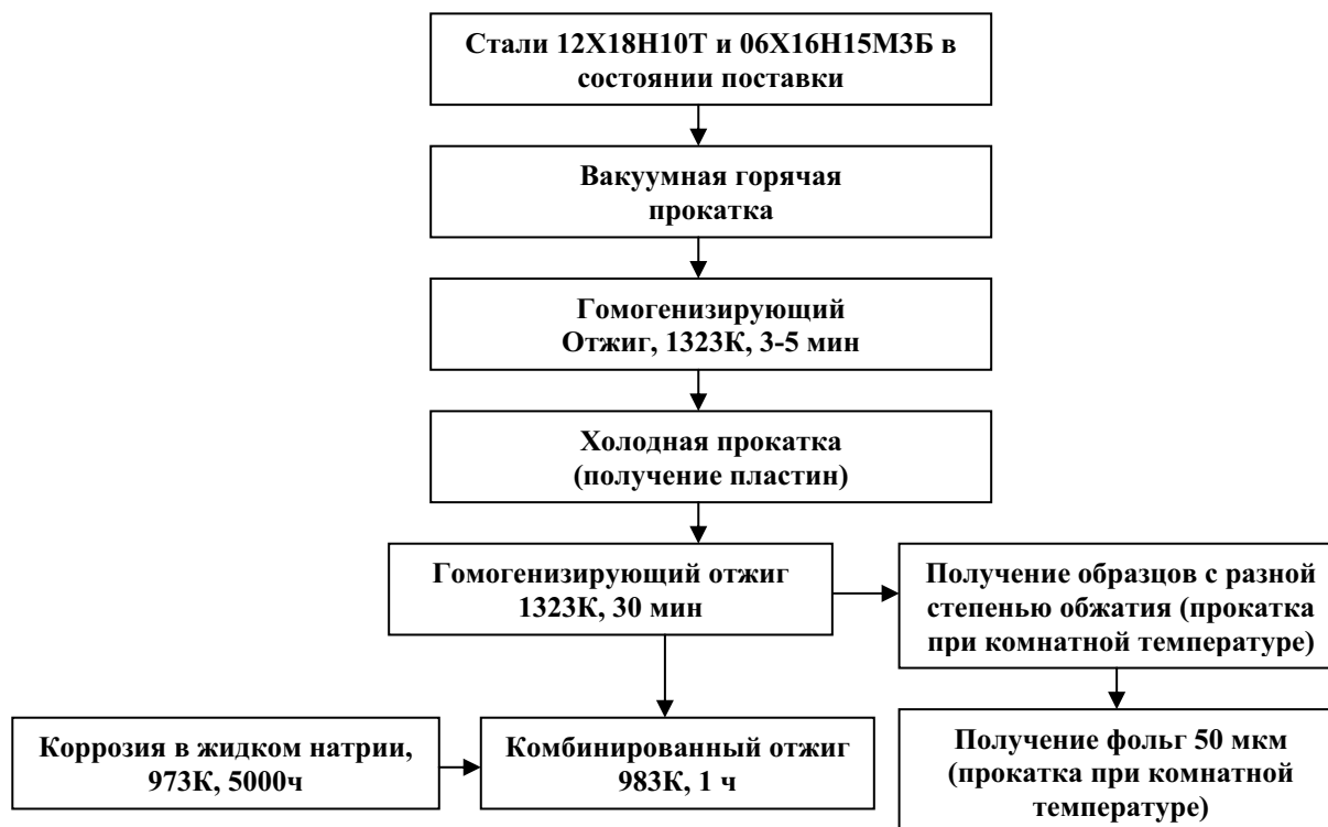
Рис.1. Схема этапов ТМО стали
