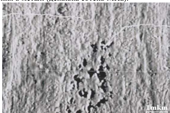
Рис. 6. Розподіл елементів по лінії сканування поверхні сплаву Zr-1,03 ат.% Fe після відпалу: а – Zr, б - Fe.
