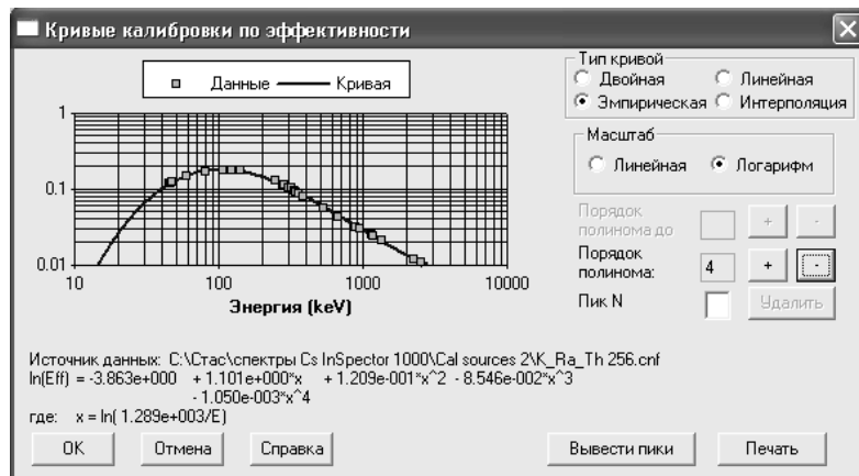
Рис. 5. Кривая эффективности регистрации гамма-квантов в интервале энергий 50...2500 кэВ сцинтилляционным детектором NaI для выбранной модели геометрии «источник-детектор».
