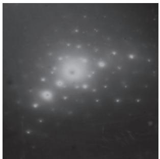
Рис. 10. Сплав Zr-0,31%Fe-1%Sn, 700°C 15ч МД
