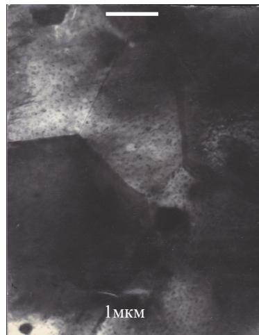
Рис. 4. Микроструктура сплава Zr-Nb-Fe при температуре отжига 700 °C 15 ч
